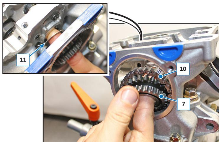
Rimuovere completamente l'ingranaggio (7) completo di rasamento (11) e lasciare cadere la catena (10) all'interno del carter.
