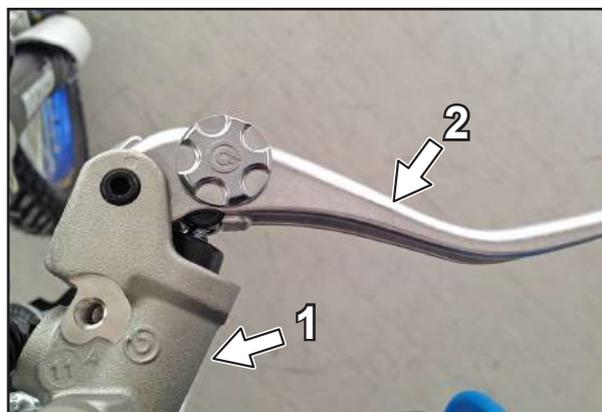
**BREMBO 16X18 RADIAL PUMP FRONT BRAKE LEVER (SMX)**
