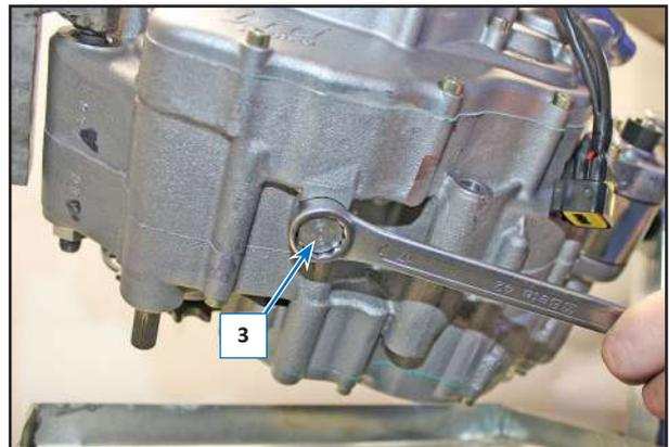
Attendere che l'olio scoli completamente dal foro di scarico, ripulire i piani di tenuta, sostituire le rondelle in alluminio (2 e 4), ripulire dai possibili detriti il magnete (5) del tappo di scarico (3) e riavvitare il tappo, serrando a 20 Nm (2 kgm, 14,75 ft/lb).
