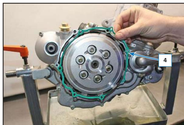
Montare il carter frizione (3) e avvitare le viti (1) e (2) in modo graduale e con una coppia di 8 Nm (0,8 kgm, 5,9 ft/lb).
