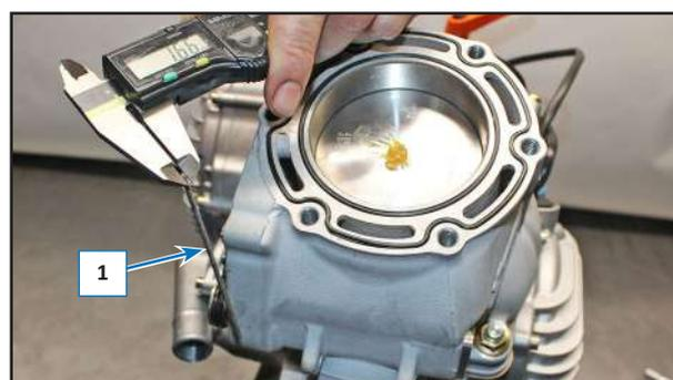
**NOTA:** Se la misura rilevata non è all'interno della misura stabilita è necessario sostituire la guarnizione (7) di base del cilindro con una di spessore adeguato alla misura rilevata.
